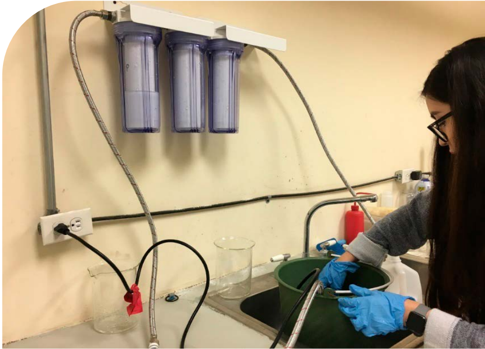
FIGURA 14. Filtros de zeolitas en serie
