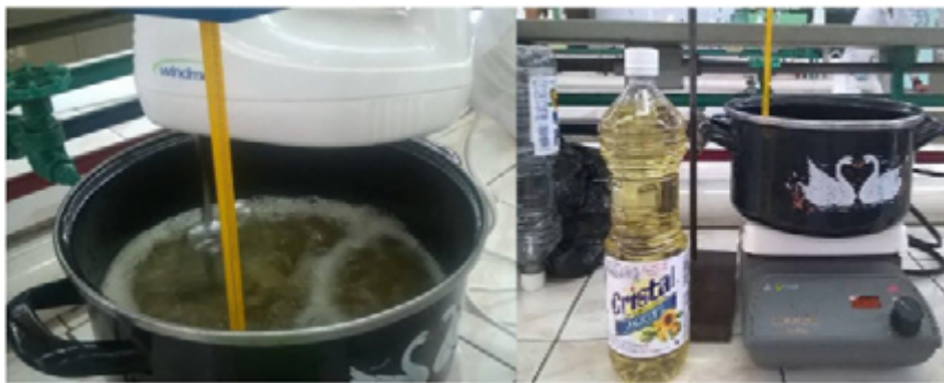
Figura 4. El procedimiento realizado, se introdujo el aceite a la temperatura deseada y el metóxido de sodio, agitando a una velocidad constante, llevando un control de la temperatura deseada.
