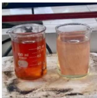
Figura 12. Comprobación de biodiesel a partir de aceite usado, con diésel normal, introduciendo placas de cobre, llevada a una temperatura aprox. de 100°C. Prueba cualitativa.
