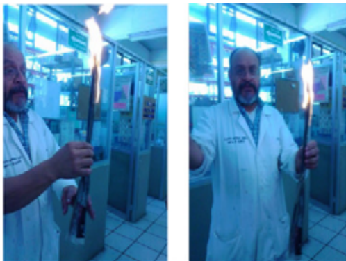
Figura. 3 Papel periódico con biodiesel haciendo combustión.
