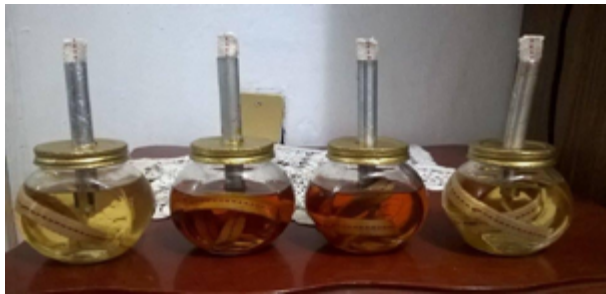
Figura 14. Mecheros que se realizaron para la comprobación del biodiesel a partir de aceite usado y nuevo marca Cristal ® , a las distintas temperaturas que fueron elaborados.
